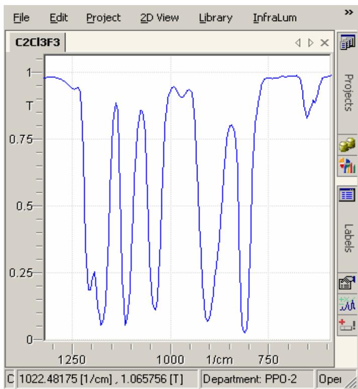
На рисунке приведен спектр пропускания  $C_2Cl_3F_3$ , зарегистрированный в диапазоне волновых чисел от 1300 до 700  $cm^{-1}$  при спектральном разрешении 4  $cm^{-1}$  и времени накопления 60 с.
